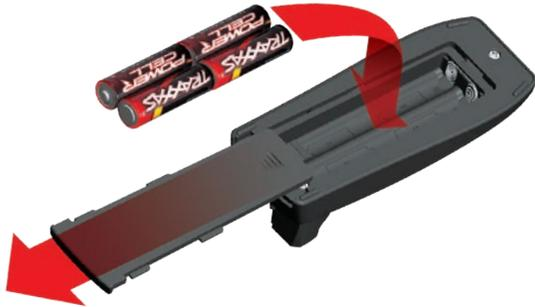
1. Para retirar la puerta del compartimento para baterías, presione la pestaña y deslice la puerta para abrirla.
