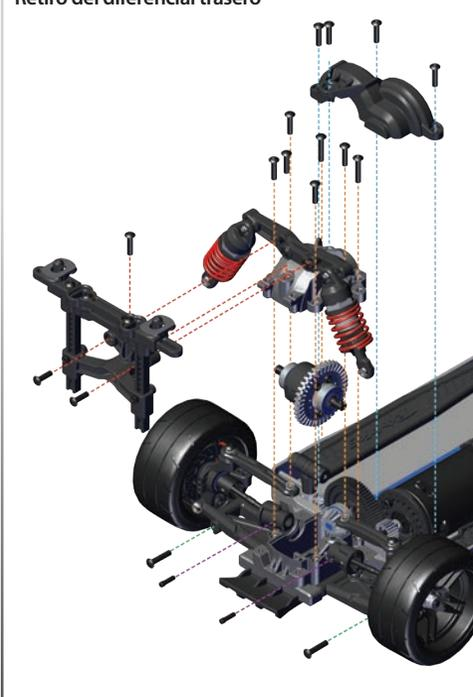
6. Retire la cubierta del diferencial y deslice el diferencial para retirar de la parte delantera de la cubierta.
